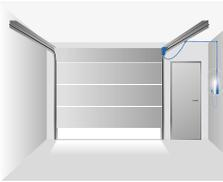
Bei verbautem Seitenanschlag, z. B. durch eine Nebentür, kann eine Kabelverlängerung eingesetzt werden.
