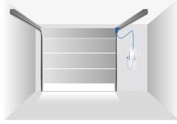
Antrieb an der rechten Torlaufschiene, Steuerung direkt neben dem Tor im Bereich des Seitenanschlags.
